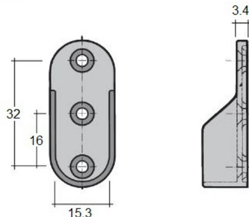
Support sous tablette Fourni avec 1 vis poêlier M6x30
