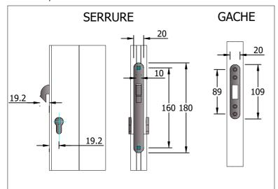
La serrure est prémontée sur le vantail et est composée de :
